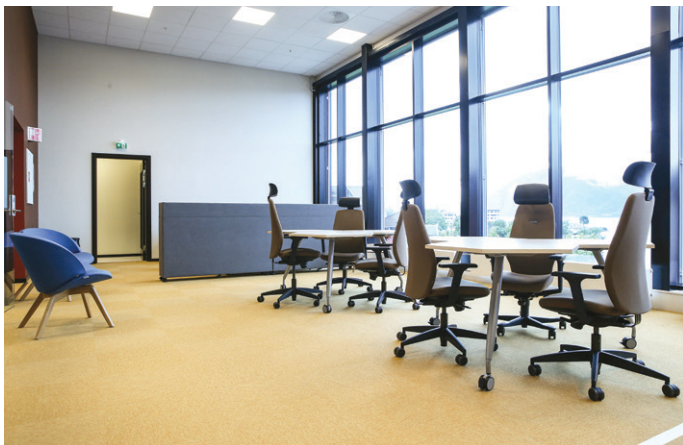
Teppeflis på gulv, malt gips på vegger og systemhimling.
