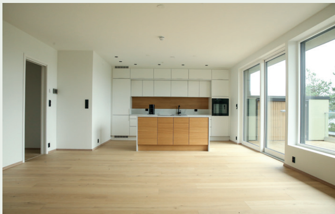
Denne 99 kvadratmeter store toppleiligheten i A-blokka var en av ti som fortsatt ikke var solgt da vi var der. Vi ser her er parkett på gulv, HTH-kjøkken og gips på vegger og i tak med listfrie overganger
