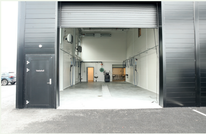
Brannbilene kjøres inn i vaskehallen etter utrykning. Brannmannskapene går gjennom barrieren i bakgrunnen der de legger klær i barrierewaske-maskinen før de går gjennom garderobe med dusj og badstue.
