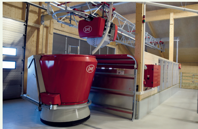
Føringsrobot med båser bak for ulike typer fôr.
